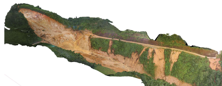
Sử dụng công nghệ tiên tiến, chụp ảnh bằng máy bay UAV để mô phỏng thực tế các khối trượt
